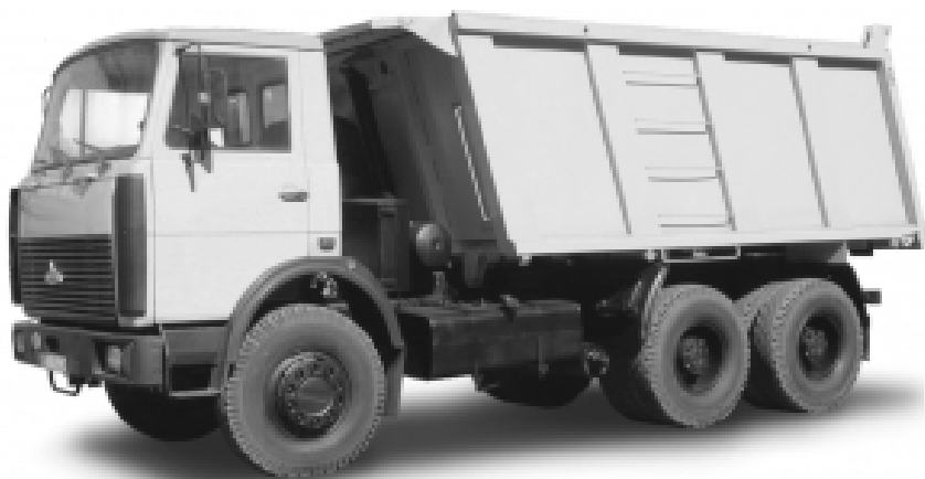
Рис. 3. Автосамосвал МАЗ-551605 грузоподъемностью 20 т производства Минского автомобильного завода
