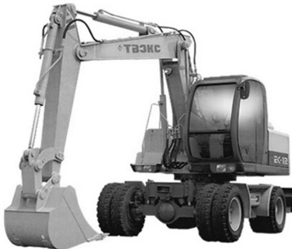
Рис. 2. Универсальные строительные экскаваторы производства Тверского экскаваторного завода: а – ЕТ-25; б – ЕК-12
